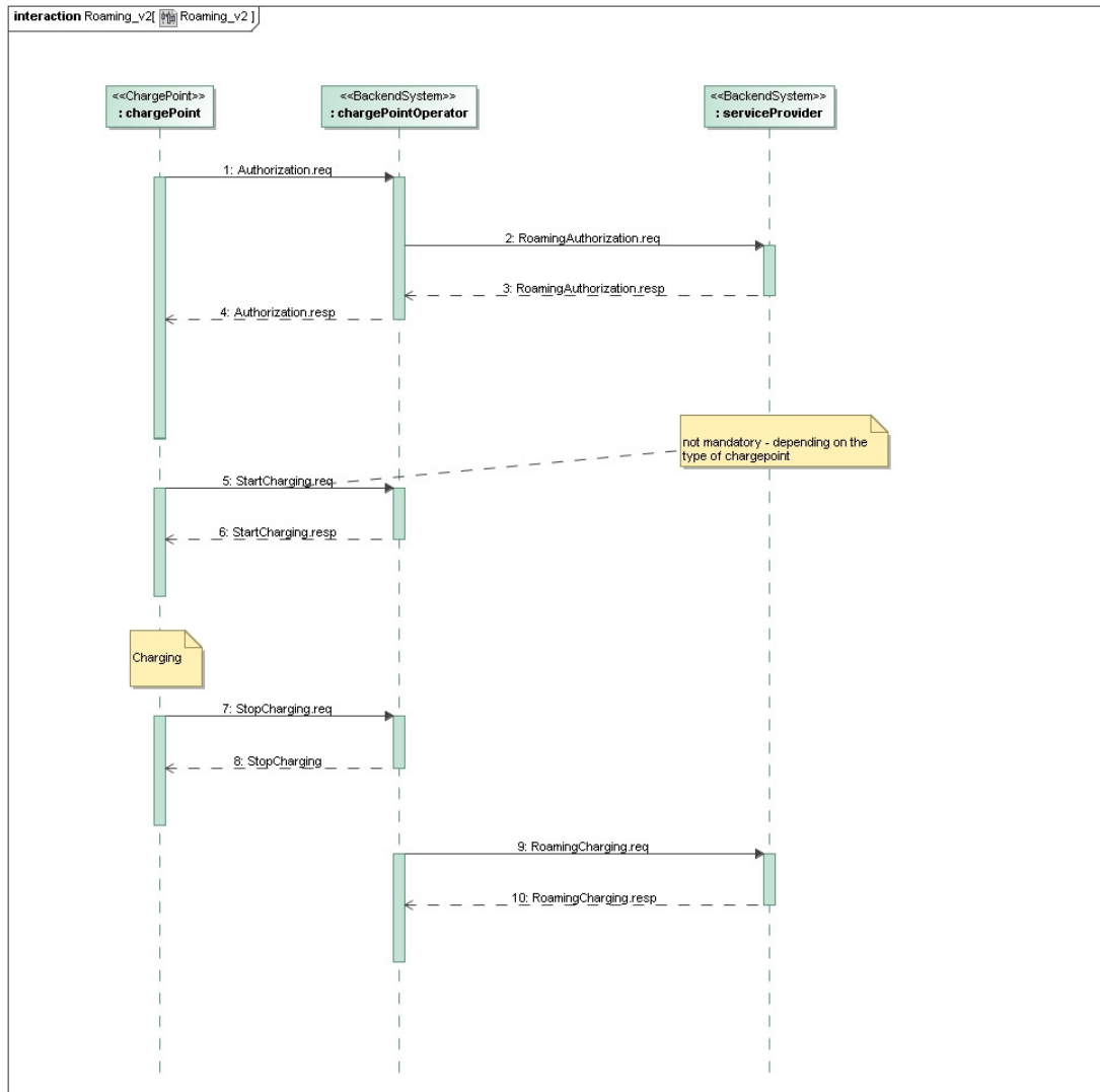
Abbildung 1: RFID-Autorisierung (AIDA) + Abrechnungsdatenaustausch (AIDA)
